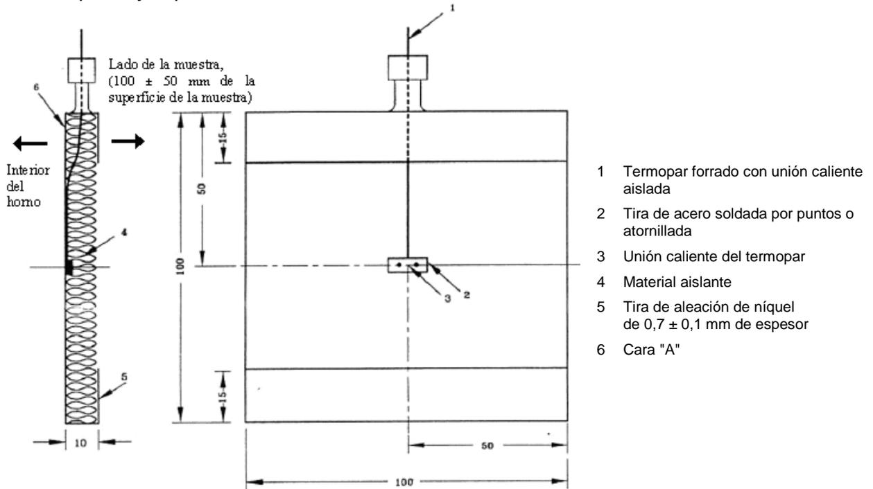
Figura 4 – Montaje de los termopares del horno
