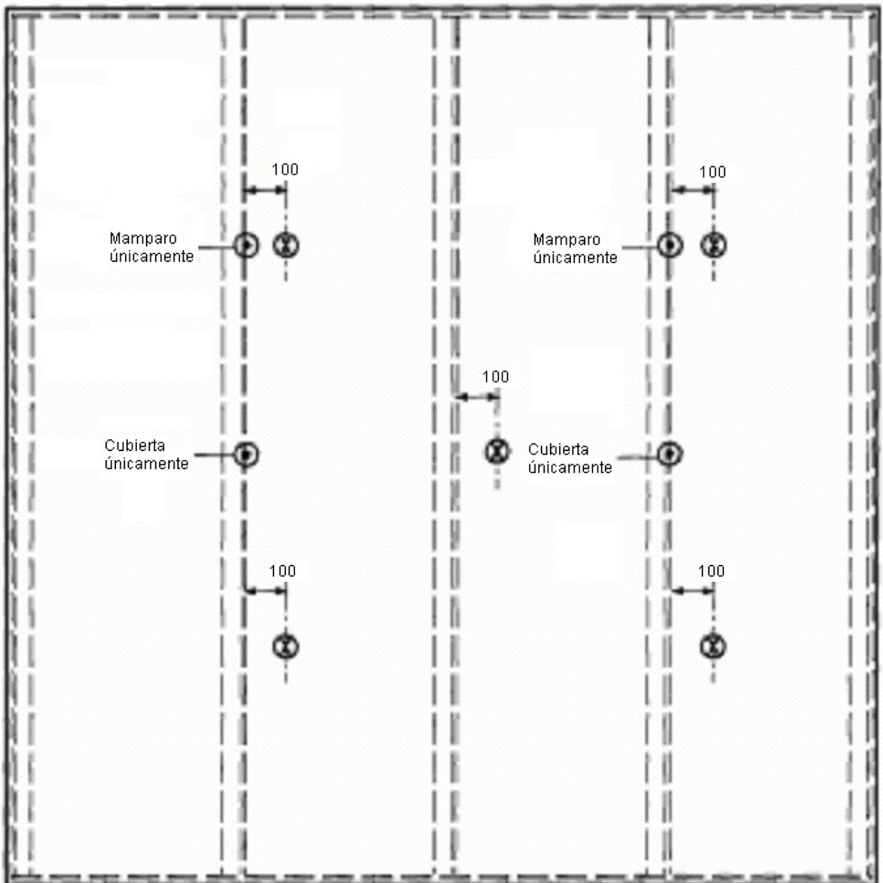
⊗ Termopares utilizados para medir el aumento máximo de temperatura y calcular el aumento medio de temperatura
