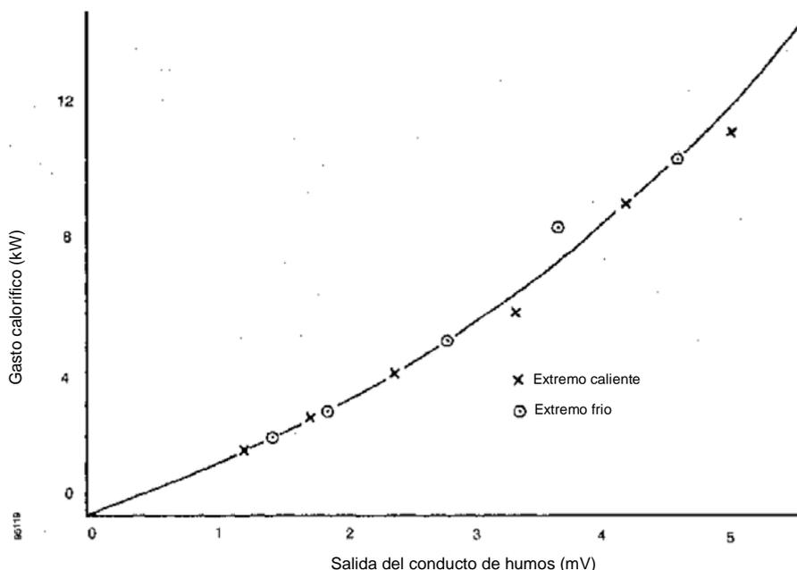
**Figura 9 – Calibración típica del conducto de humos**
