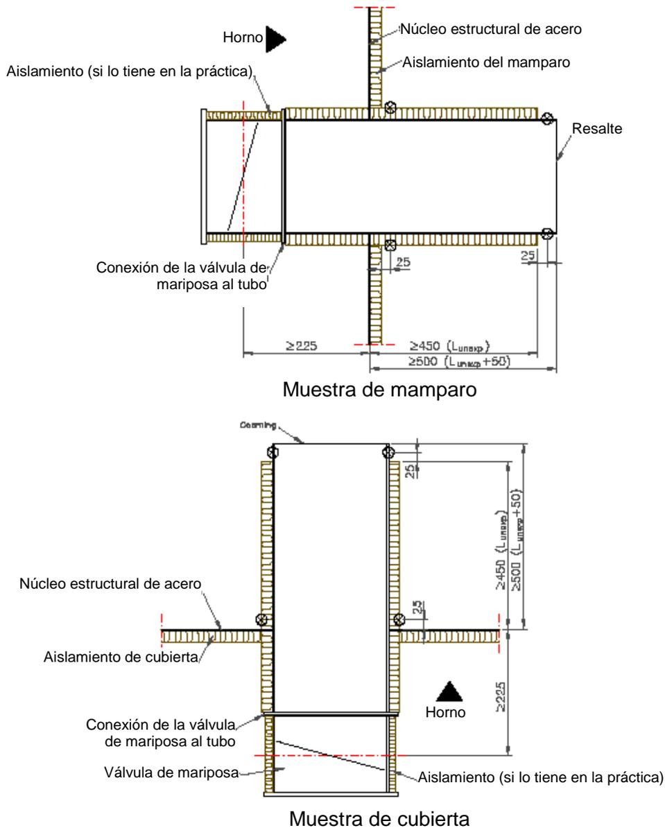
$L_{unexp}$  = Longitud de aislamiento necesaria para una válvula de mariposa sometida a ensayo
