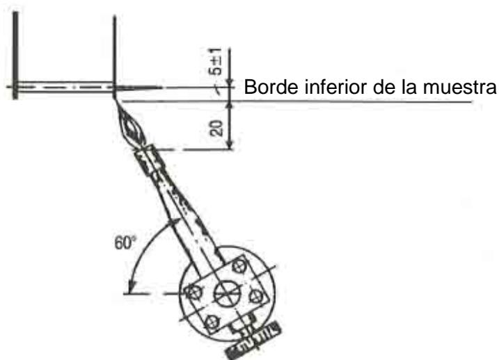
**Figura 2 – Quemador de gas: posiciones del tejido**
