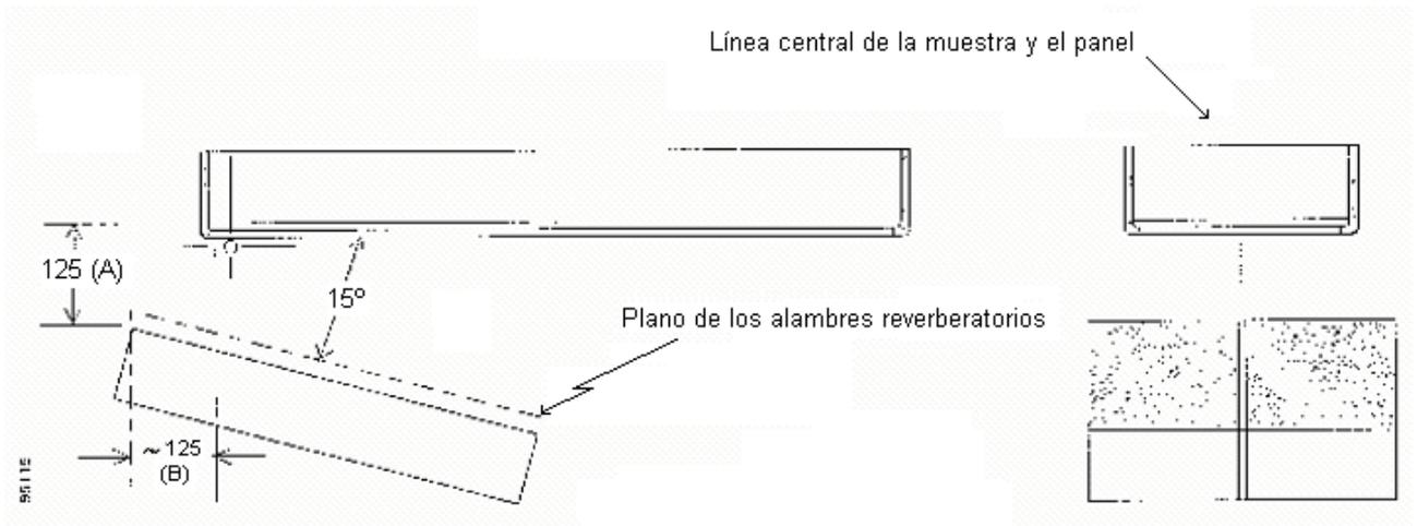
**Figura 3 – Disposición de la muestra y el panel**
