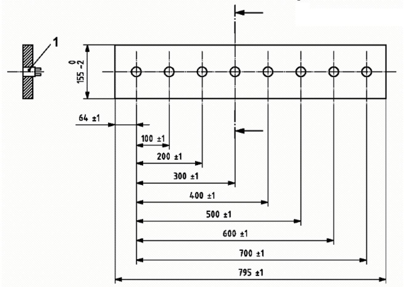
1 Medidor del flujo calorífico que calza ajustado en el orificio de 25 mm de diámetro (p. ej., para medir a 300 mm)
