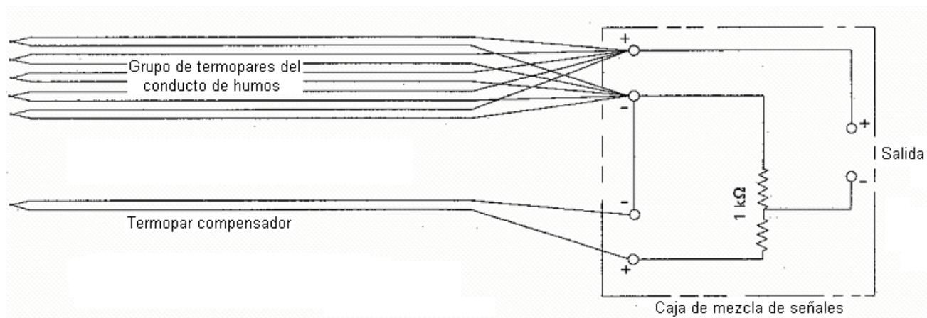
Figura 7 – Diagrama de un circuito de termopares
